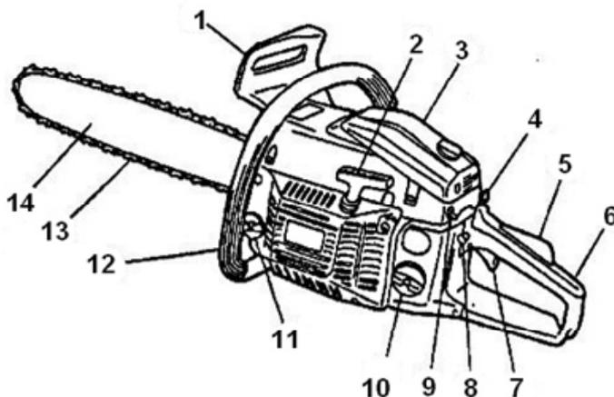
1. Переднее защитное устройство с функцией тормоза цепи
